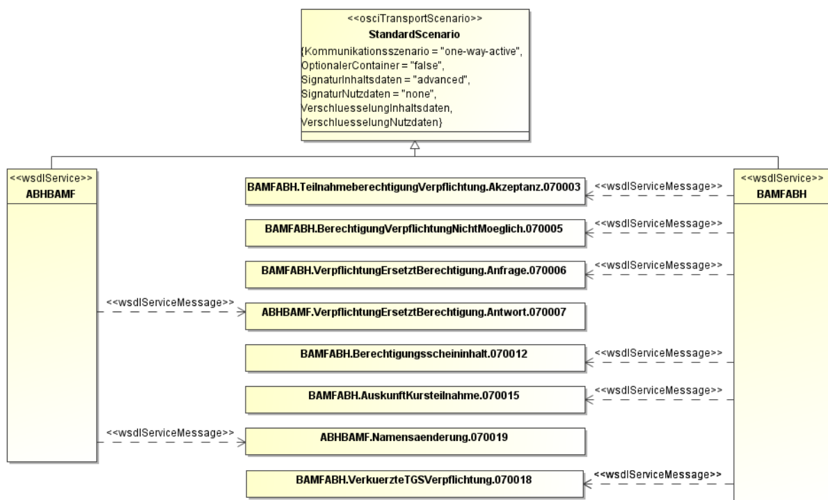
Abbildung C.2. Nachrichten zur asynchronen Verwendung
